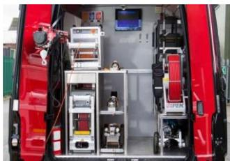
В техническом отсеке монтируется прочный металлический каркас для кабельного барабана с ящиками для хранения роботов и аксессуаров. Также в каркас устанавливается генератор (если не были выбраны аккумуляторные батареи с инвертором), плавающий модуль (плот), отопительная система для отсека, бак для воды с насосом и устройство для мойки кабеля и роботов.
