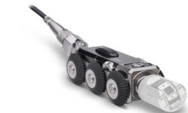
Транспортер RX95 для труб диаметром 100–200 мм поворотный, привод на 6 колёс, включая комплект стандартных колёс (6 шт.), устройство спуска, аксессуары, транспортировочный кейс.
