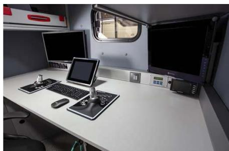
В отсеке оператора оборудуется рабочее место позволяющее управлять всеми узлами и механизмами системы. Представляет собой эргономичный стол, на котором расположены: пульт управления системой телеинспекции IPEK ROVION, монитор (один или более), персональный компьютер для записи и хранения видео с объектов исследования (на ПК может быть установлено дополнительное ПО для анализа полученных с объектов
