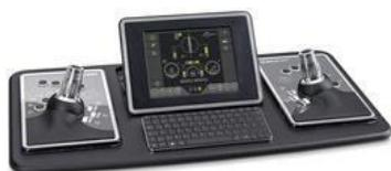
Стационарная панель управления DCX5000 с сенсорным дисплеем, с общей рамкой для установки в автомобиль, включая CCUI
