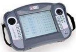
Новый пульт VisionControl был разработан на базе системы телеинспекции труб и трубопроводов SUPERVISION, и послужит основой для дальнейших разработок пультов компании iPEK.
